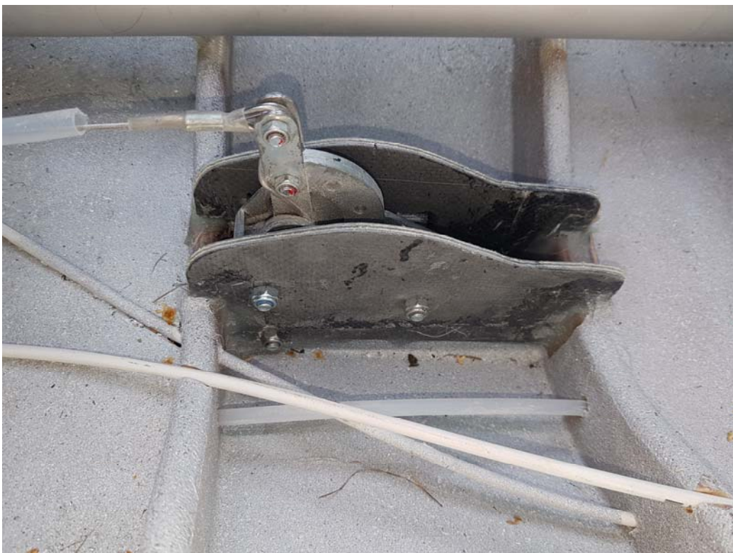
Die Tost Schleppklinke garantiert präzises handling und stete Kontrolle, auch während des Schlepps; Wartung und Pflege, ohne Montageaufwand, bester Überblick, ohne zu Stören;
