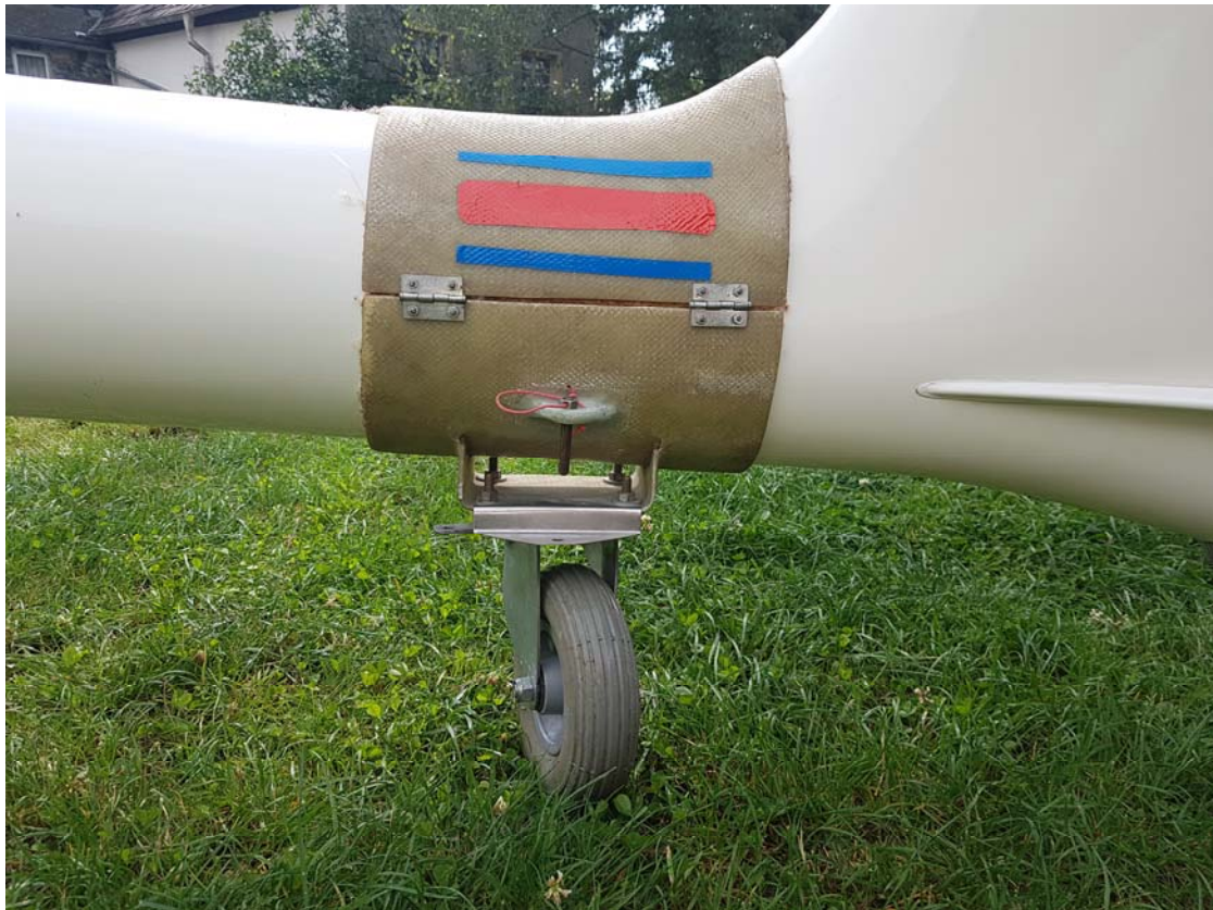
Transportkullerchen des Schwanzes, vom Transporthänger bis zu Startstelle; mit einem Handgriff An- und ablegen, ohne fremde Hilfe;
